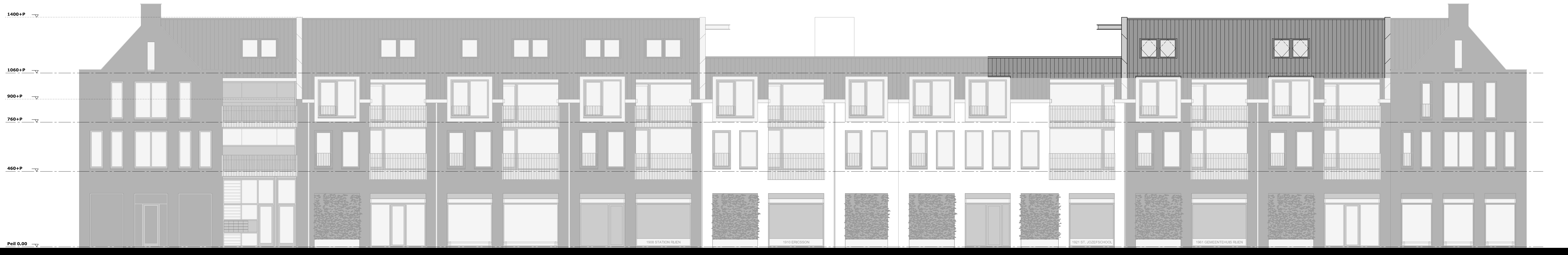
voorgevel appartement 20 (schaal 1:100)
